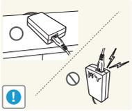
Si vous placez l'adaptateur CA/CC de sorte qu'il est accroché avec le cordon d'alimentation vers le haut, de l'eau ou d'autres substances étrangères pourraient entrer dans l'adaptateur et provoquer un dysfonctionnement dans celui-ci.
