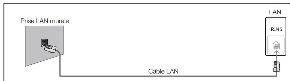
Si vous disposez d'un réseau dynamique, vous devriez utiliser un modem ADSL ou un routeur qui prend en charge le protocole DHCP (Dynamic Host Configuration Protocol). Les modems et routeurs qui prennent en charge DHCP fournissent automatiquement les valeurs d'adresse IP, de masque de sous-réseau, de passerelle et de DNS nécessaires à votre produit pour accéder à Internet ; vous n'avez donc pas à les entrer manuellement. La plupart des réseaux domestiques sont des réseaux dynamiques.
